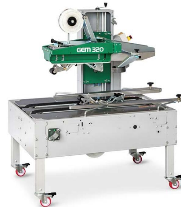
GEM 320 è dotata di un sistema di avanzamento delle scatole ottenuto mediante nastri di trascinamento inferiori orizzontali. Il gruppo nastrante superiore è dotato di un sistema brevettato che consente mediante la regolazione di una molla di predeterminare il peso che andrà a gravare sulla scatola e di assorbire, quindi, eventuali differenze in altezza delle scatole.
